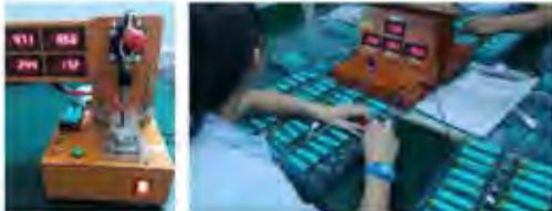
100% Kontrolle auf die Druckplatte mit den darauf montierten Komponenten. Die Lötstelle wird 1:1 kontrolliert und es findet ein ausgeprägter Funktionscheck statt. Ungeeignete Komponenten verursachen einen nicht konstanten Power Input und Output, der Ihr Handy oder Tablet beschädigen kann. 100% Widerstandstest. Das ist sehr wichtig, weil eine unbrauchbare Batterie warm werden und dann explodieren oder Feuer fangen kann.
