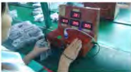
Die Batterie wird an der Druckplatte befestigt und dies Halbfabrikat wird 100% auf Sicherheit und Leistung getestet: die Kurzschlussicherheit, die Input und Output Voltzahl sowie die Stabilität dazu werden kontrolliert.
